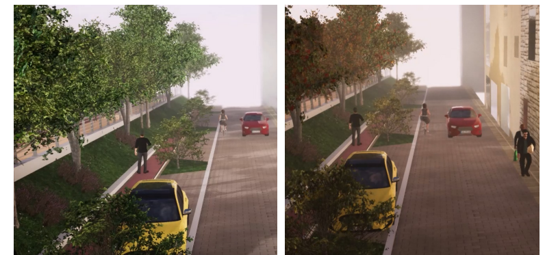
Images extraites d'une vidéo réalisée avec le logiciel Twinmotion sur une base sketchup pour montrer l'évolution des ombrages au fil de l'année ( Avril et Octobre ici) Rueil Malmaison, aménagement de la contre-allée sur la RD 39
